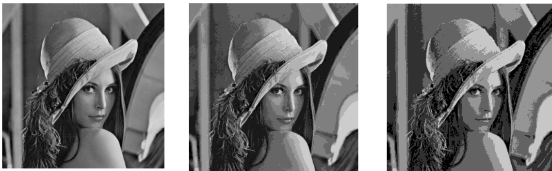
Slika 18. Efekat korištenja različitog broja nivoa sivila. S lijeva na desno: digitalizacija slike "Lena" sa 256, 64 i 16 nivoa sivila
