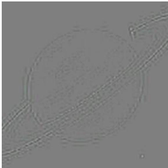
rekonstruisana slika na osnovu 20 DCT koeficijenata (32x32 blok), slika greške
