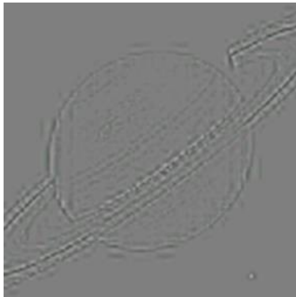
rekonstruisana slika na osnovu 12 DCT koeficijenata (32x32 blok), slika greške
