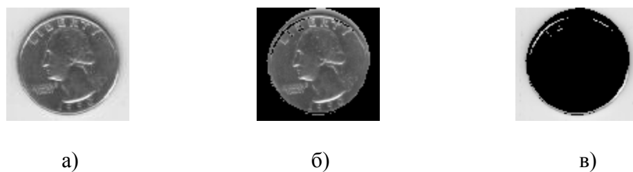
Слика 3.3 - (а) оргинална слика ( 82 \times 89 ). Сlike б) - в) показују добијене регионе, гдје је N_{cut} вриједност мања од 0.008. Вриједности параметара: \sigma_I = 0.08 , \sigma_X = 15 , r = 7
