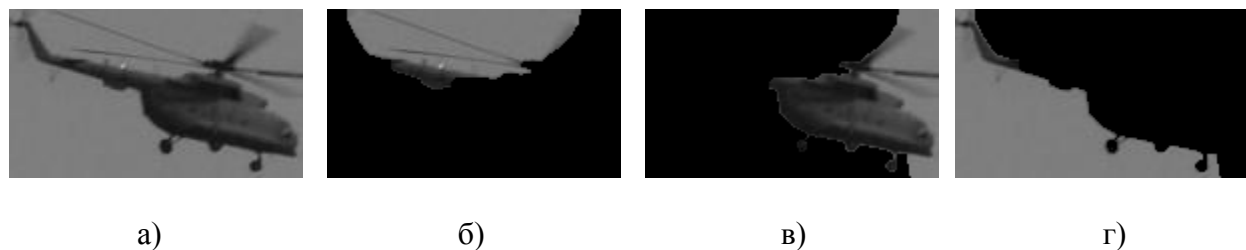
Слика 3.6 – а) оригинална слика ( 84 \times 147 ). Сlike б) – г) приказују добијене регионе, гдје је N_{cut} вриједност мања од 0.03. Вриједности параметара: \sigma_I = 0.08 , \sigma_X = 10 , r = 5
