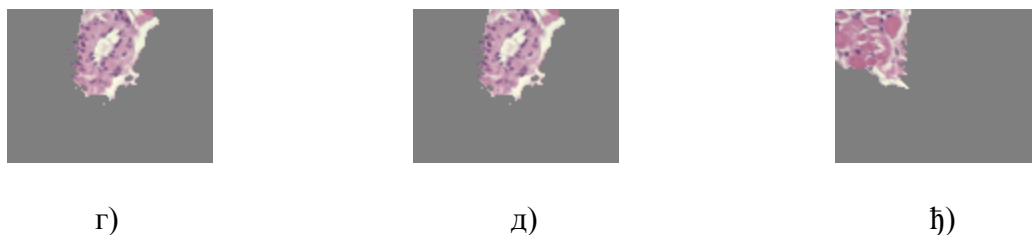
Слика 4.12 – а) оригинална слика ( 103 \times 77 ). Сlike б) – њ) приказују добијене регионе, гдје је N_{cut} вриједност мања од 0.08. Вриједности параметара: \sigma_1 = 0.06 , \sigma_x = 4 , r = 7
