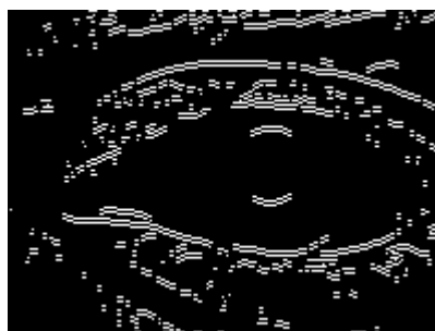
Slika 4.3 - Detekcija horizontalnih ivica Sobelovim metodom
